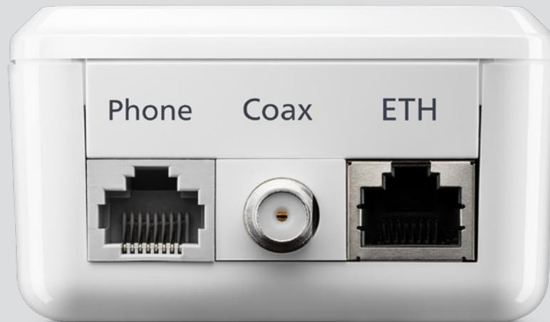
Der Anschluss des zweiten devolo Giga Bridge-Adapters mit dem Router im Wohnraum erfolgt, je nach gewählter Verkabelungsart, über Koaxial- (Coax) oder Telefonkabel (Phone); Quelle: devolo AG
