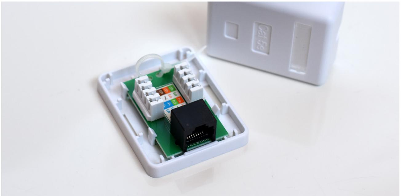
Das Telefonkabel, das vorher im APL zu finden war, wird zuerst entfernt und anschließend aufgesplittet und kontaktiert, um daraus eine vollwertige Netzwerkschnittstelle zu machen. Die devolo Giga Bridge kann nun via Ethernet Patchkabeln am Phone-Port mit Auslassdose und am ETH Port mit dem NT/ONT verbunden werden; Quelle: devolo AG
